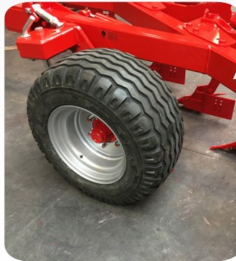
Transport and depth wheel. Mini N - 340/55 R16 Mini S - 500/50 R17
