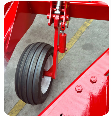
Front depth control wheel. Mini N option - 200/60 R14.5 Mini S standard - 250/65 R14.5
